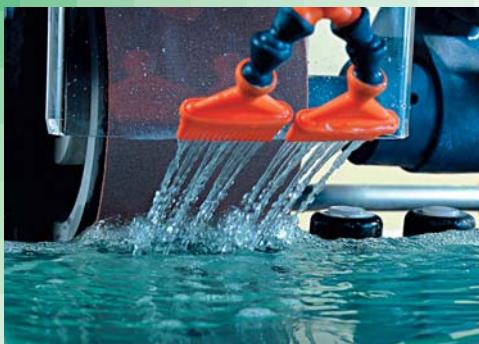
Алмазные шлифленты 3M™ Flexible Diamond созданы на основе новой технологии компании 3M точного и контролируемого нанесения алмазного зерна на металлическую связку. Металлические подложки, надежно удерживающие алмазное зерно, размещены на высокопрочной гибкой основе. Максимально открытая структура размещения абразивного зерна обеспечивает агрессивное резание, а долговечность и прочность металлической связки – высокую стойкость абразивной ленты и качество обрабатываемой поверхности.
