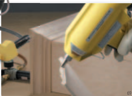
Благодаря тонкой линии соединения клей PUR 250 сохранит эстетику молдинга
