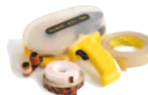
Клеепереносящие (безосновные) ленты – это тонкий слой клея на лайнере. Для легкой и быстрой работы с такими лентами разработан специальный аппликатор Scotch® ATG 700, который легким нажатием курка наносит клей на поверхность и одновременно снимает и сматывает лайнер в рулон. Ленты данного семейства предназначены для удобного и быстрого склеивания бумаги и картона, тканей, пленок и фольги, пластиков и других материалов.
