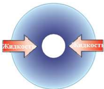
Рис.1 Структура Betapure™ BK-Z2 с градиентом пористости
