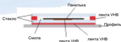
*Прозрачная лента VHB использована для присоединения элементов солнечной панели*
