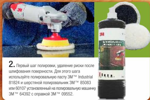
**2.** Первый шаг полировки, удаление риски после шлифования поверхности. Для этого шага используйте полировальную пасту 3M™ Industrial 81824 и шерстяной полировальник 3M™ 85083 или 60107 установленный на полировальную машинку 3M™ 64392 с оправкой 3M™ 09552.
