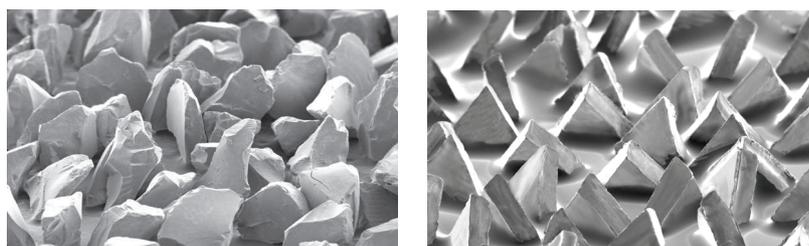
Зерна минерала Cubitron™ II имеют прецизионную пирамидальную форму и строго ориентированы на основе. Они режут металл, как ножом, обеспечивая высокое качество поверхности, и продолжают оставаться острыми до полного стачивания.
