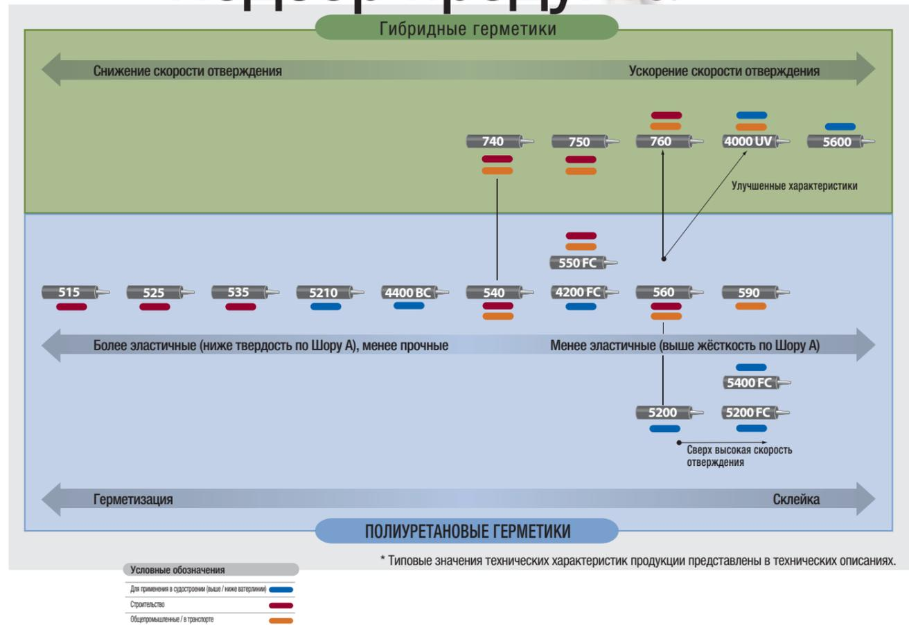
В данном разделе графически представлен диапазон применения полиуретановых и гибридных клеев и герметиков 3М™. Не следует забывать о том, что скорость отверждения большинства клеев и герметиков возрастает в условиях повышенной температуры и повышенной влажности. Учитывая это, компания 3М включила в ассортимент герметики с различным временем образования плёнки. Возможен подбор оптимального герметика для каждого производственного процесса с учетом климатических условий на производстве.
