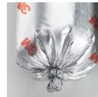
Обжатие концов колбас герметика 3M по сравнению с закреплением концов колбас проволокой способствует увеличению срока хранения герметика за счет предотвращения доступа внутрь упаковки влаги. В случае проникновения влаги внутрь упаковки может начаться преждевременное отверждение материала, что приводит к его утилизации.
