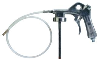
Пневматический пистолет для нанесения мастики в упаковках вместимостью 1 л или массой 1 кг. Этот специальный пульвер позволяет покрытию проникнуть глубже в труднодоступные участки. Благодаря равномерному распылению мастики из носика мастер может защитить даже самые объемные полости, обработать изнутри пороги, капоты, двери и т. п.
