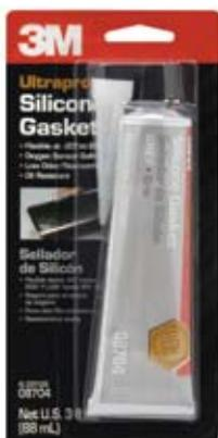
Быстро сохнущий, формирующийся клей-герметик для использования в автомобильных двигателях. Этот эластичный, не корродирующий состав может применяться для уплотнения крышки клапанов, поддона картера и других соединений на двигателе и коробке передач. Эффективен при температуре от -29 °С до 301 °С.
