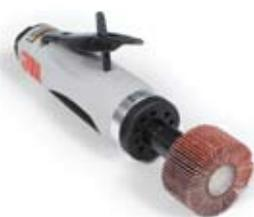
Прямые шлифовальные машинки 3М™ с пневмоприводом отличаются высокой мощностью, небольшим весом, компактными размерами и низким уровнем вибрации. Специальный предохранитель, предотвращающий случайный запуск машинки, обеспечивает безопасность работы. Материал покрытия рукоятки помогает удерживать инструмент с минимальными усилиями, а возможность регулировать направление отвода воздуха создает дополнительный комфорт при работе.
