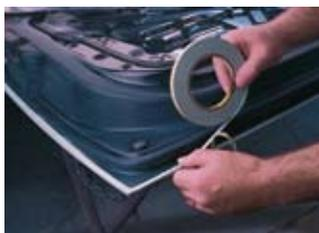
Шовная лента-герметик разработана для воссоздания заводского шва на стыках внахлест.
