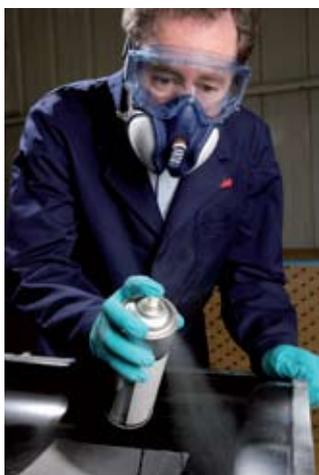
Представляет собой насыщенное цинком сварочное покрытие для точечной и дуговой сварки.
