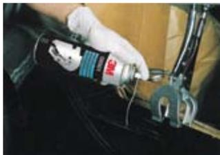
Материал формирует защитное покрытие в скрытых полостях кузова. За счет капиллярного эффекта, материал проникает в труднодоступные места и сварные швы, обеспечивая долговечную защиту от коррозии.
