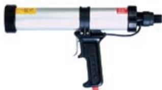
Легкий пневматический пистолет с регулятором давления, действующим по принципу «клапана сброса», что обеспечивает сброс давления на поршень сразу после отпускания курка. Применяется для нанесения выжимных герметиков в картриджах вместимостью 290, 310 мл.
