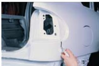
Представляет собой прочный и гибкий материал, применяемый для заделки швов шириной 2 – 3 мм.
