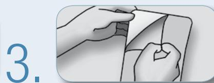
Скруглите углы заготовки материала, отрезанной от рулона. Отогните защитную подложку с одного края заготовки и приложите ее к поверхности. Старайтесь не прикасаться к клеевому слою. При наклеивании материала 3M Safety-Walk™ на ступеньки отступите от края на 12–15 мм, чтобы избежать скручивания и преждевременного износа покрытия.
