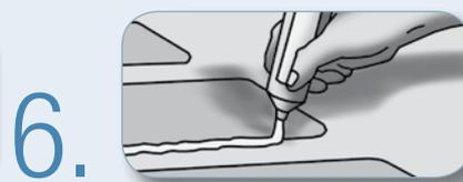
При использовании на влажных поверхностях, нанесите герметик 3M Safety-Walk Edge Sealing Compound по краям заготовки. Герметик должен покрывать как края материала, так и участки пола вдоль краев. Ходжение разрешается после полного высыхания герметика (обычно через 30 минут).
