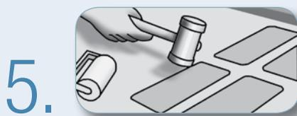
Резиновым валиком прикатайте материал к поверхности. При нанесении формируемого материала 3M Safety-Walk™ обработайте поверхность легкими ударами резиновой киянки, чтобы улучшить прилегание заготовки к неровной поверхности.
