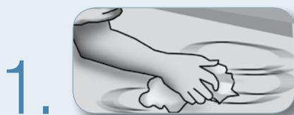
Очистите поверхность обезжиривающим составом (например, промышленным очистителем 3M), удалите грязь и следы масел. Ополосните поверхность водой и тщательно просушите. Перед наклеиванием материала поверхность должна иметь температуру не ниже 4 °C (или 10 °C – для эластичной тонкой ленты для влажных помещений).
