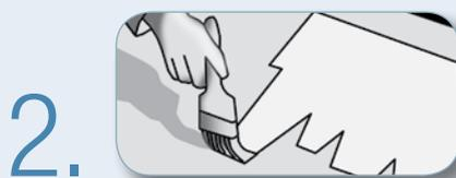
На шероховатых или гладких пористых поверхностях (некрашенные деревянные, бетонные или каменные полы): кистью нанесите грунтовку (3M Scotch-Grip™ 2141, или Fast-Bond™ 10, или Scotch-Clad™ 776) на место приклеивания материала 3M Safety-Walk™. Тщательно просушите грунтовку.
