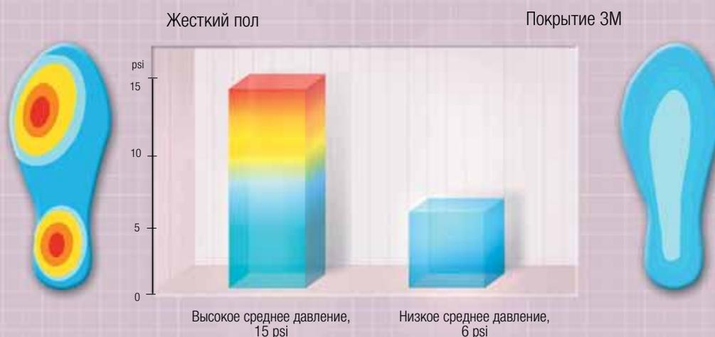
Как видно из диаграммы, покрытия 3M со спиралевидной структурой эффективно распределяют нагрузку в плоскости контакта обуви с полом, что исключает возникновение зон концентрированного повышенного давления и снижает среднюю нагрузку на опорно-двигательный аппарат человека в целом.
