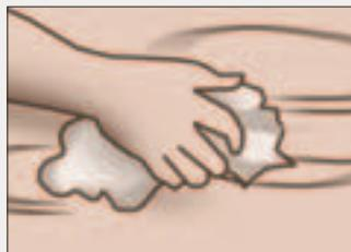
1. Очистите поверхность обезжирающим составом (например, промышленным очистителем 3М), удалите грязь и следы масел. Ополосните поверхность водой и тщательно просушите. Перед наклеиванием материала поверхность должна иметь температуру не ниже 4 °C (или 10 °C – для эластичной тонкой ленты для влажных помещений).
