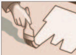
2. На шероховатых или гладких пористых поверхностях (некрашеные деревянные, бетонные или каменные полы): кистью нанесите грунтовку (3M Fast-Bond™ 10) на место приклеивания материала 3М Safety-Walk™. Тщательно просушите грунтовку.
